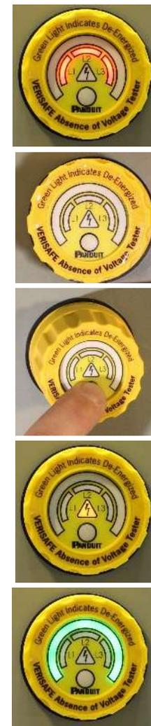
VeriSafe™ Spannungsfreiheit Tester verwenden aktive visuelle Indikatoren, die den Spannungsstatus in elektrischen Geräten vor dem Zugriff anzeigen, wodurch die Gefährdung durch Elektrizität verringert wird und die Arbeiter geschützt werden.
